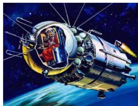
La navicella spaziale si chiamava Vostok, che in russo significa "oriente". Era costituita da due parti: un modulo di forma sferica, che ospitava l'astronauta (la capsula) ed un modulo di servizio con la strumentazione di bordo ed i retrorazzi necessari al rientro a ter-
